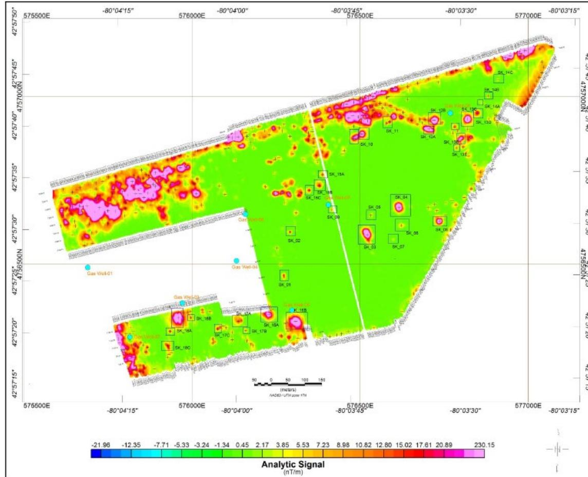
Possibilité d'obtenir une carte précise avec un espacement de lignes serré de 5 m avec un remplissage de 2,5 m pour détecter les petits puits de gaz.
